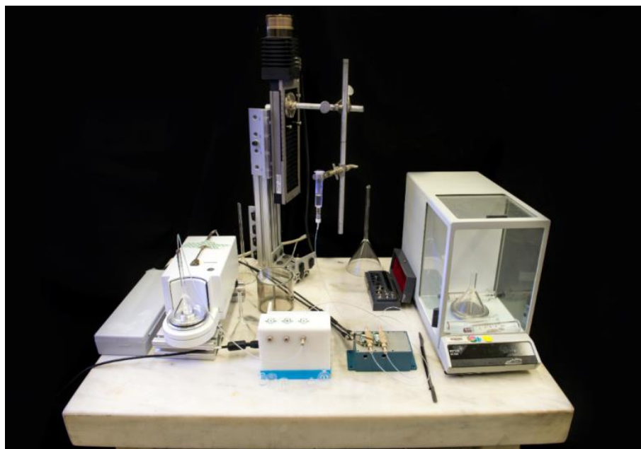
Рисунок 1.1 – Гравиметрический измеритель микропотока
