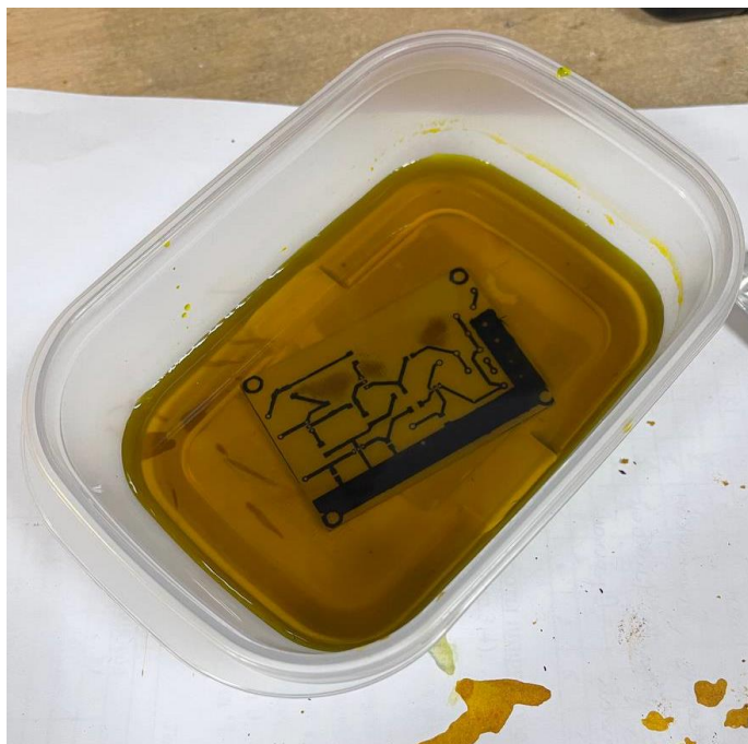
Рисунок 3.4 – Травление платы в хлорном железе
